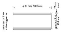
LARGE TRIANGLES OF 900mm OR GREATER USE MINIMUM OF 3 No HORIZONTAL STIFFENERS
